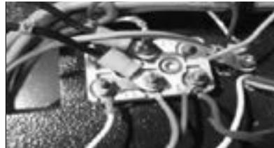
6. Con el desarmador de cruz abrir la abrazadera y desmontar el capacitor (Imagen 18).
