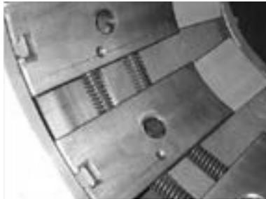
18. Colocar el par de resortes entre cada mordaza base hasta que estén completados los 8 juegos. Para montar el último par de resortes, hacer palanca entre las mordazas con un destornillador (Imagen 47 y 48).
