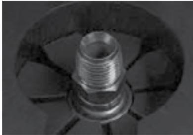
4. Extraiga la conexión y cheque el diámetro de crimpado, que debe medir 1.000" ± 0.003".
