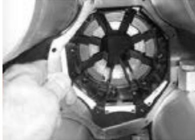
7. Montar y apretar los tornillos del anillo de fijación (Imagen 35).
