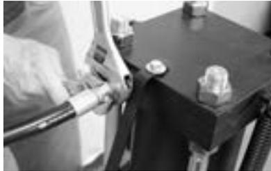
11. Retire la conexión giratoria de la placa superior de la crimpadora (imagen 46).
