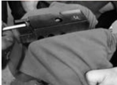
**NOTA: EN OCASIONES SERÁ NECESARIO RETIRAR EL PERNO UTILIZANDO UN MARTILLO Y UN PUNZÓN O CINCEL, GOLPEANDO EN DIRECCIÓN DEL TORNILLO TOPE HACIA EL PERNO COMO SE MUESTRA EN LA IMAGEN 57.**
