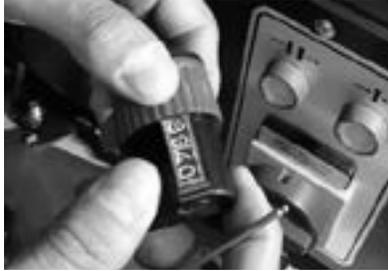
5. Después girar con la mano el tornillo sinfín ayudándose de la parte de bronce en la que antes estaba sujeto el contador, llevando el tornillo sinfín hasta la posición de retracción total, lo cual será hasta que toque la placa suavemente (Imagen 8).
