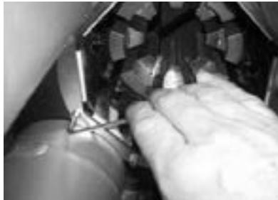
**NOTA: SI EL USO DE LA MÁQUINA ES CONSTANTE (24/7) SE RECOMIENDA EL CAMBIO DE PLATINAS AL MENOS UNA VEZ AL AÑO O CUANDO EL DESGASTE ASÍ LO REQUIERA.**
