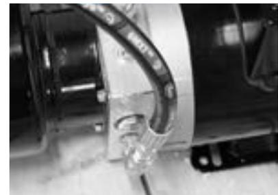
7. Verifique que el interruptor en la caja eléctrica de la bomba esté en la posición "OFF". Conecte el cable de alimentación de la bomba a un circuito eléctrico nominal de 15 amperes (mínimo). Después abrir el switch de la bomba moviendo el interruptor a la posición ON.
