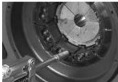
13. Finalmente vamos a colocar cada uno de los dados utilizando la Herramienta de Cambio Rápido (QCT), cargando los dados dentro de los espacios designados para éstos en el rack suministrado como se muestra en la imagen 12. La disponibilidad de los dados se puede realizar por ambos lados del Rack.
