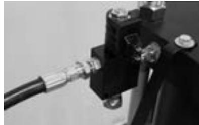
4. Conecte la línea de presión en el puerto 3 del bloque de la válvula (imagen 50).
