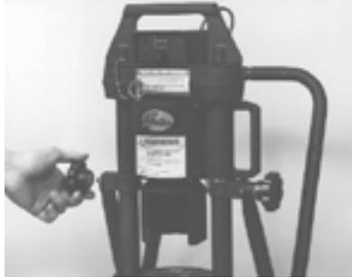
3. Deslice las dos mitades del soporte juntos y adjuntar la crimpadora en los pernos de pivote (Imagen 3).
