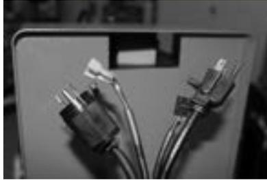
7. Alinee las dos perforaciones de la carcasa negra con los tornillos roscados y empuje suavemente la placa posterior en su lugar. Coloque el extremo del cable de conexión verde a tierra en el tornillo roscado izquierdo (imagen 58).
