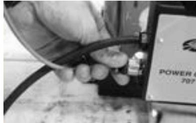
4. Retire el switch box de la crimpadora quitando los dos tornillos que la sostienen a la base de la crimpadora (imagen 37 y 38). Éstos pueden encontrarse en el costado o en la parte superior de la base dependiendo de su modelo.
