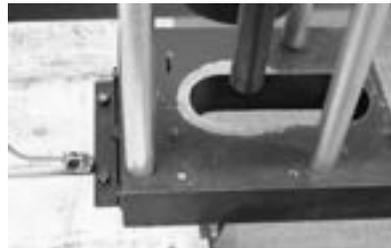
5. Retire los dos tornillos Allen de la parte delantera de la cubierta naranja (imagen 39).
