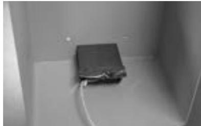
Quite la cara de la pantalla, quite los tornillos de la pantalla y retire la unidad de visualización y el cable de la parte posterior de la cubierta.
