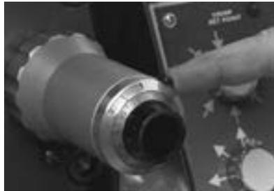
4. Utilizando una conexión MegaCrimp® 8G, vamos a colocarla cuidando que la misma esté 1/8" por debajo de la orilla del tope del dado.
