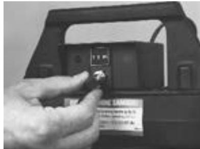
9. Aflojar los 2 tornillos de la perilla de latón de ¼ a ½ giro usando la llave Allen de 0.05" (Imagen 13).
