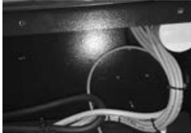
5. Retirar la cubierta metálica que está al lado derecho del cabezal de prensado, sacando los 4 tornillos Allen que la sujetan para tener acceso a la bornera del motor (Imagen 18 y 19).
